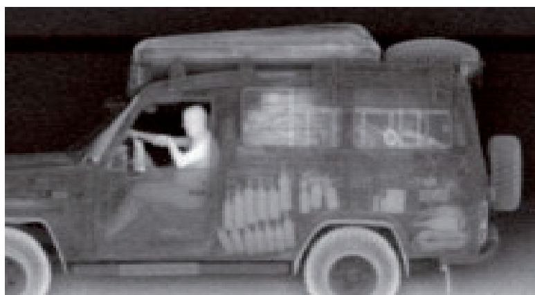
Рис. 5. Образец изображения автомобиля и его содержимого, полученного с помощью мобильного сканера обратного рассеивания
