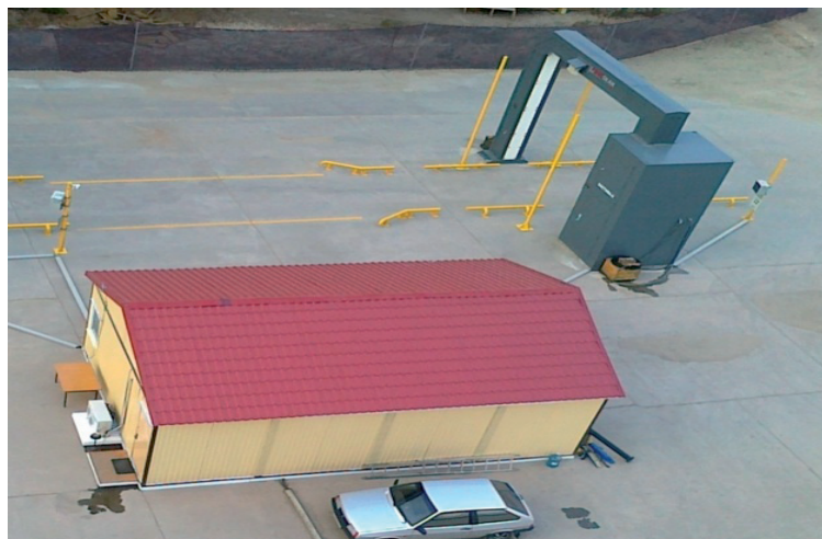
Рис. 3. Инспекционно-досмотровый комплекс портального типа предприятия ЗАО «ИндиКом» (г. Санкт-Петербург)
