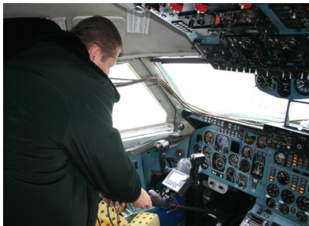
Рис. 1. Досмотр кабины экипажа воздушного судна с применением ТСТК
