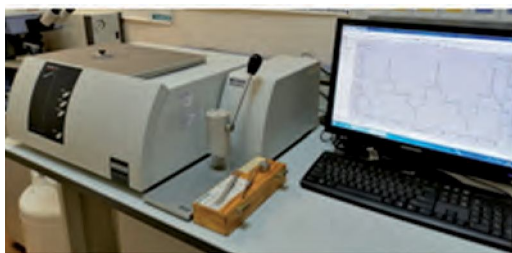
Рис. 6. Универсальный дифференциальный сканирующий калориметр DSC 20 F1 Phoenix
