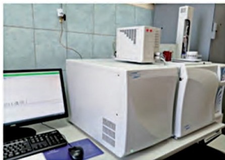
Рис. 4. Аппаратно-программный комплекс «Хроматэк-Кристалл 5000» с масс-спектрометрическим детектором
