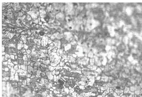
Рис. 1. Горячая деформация, остывание в печи, x200
