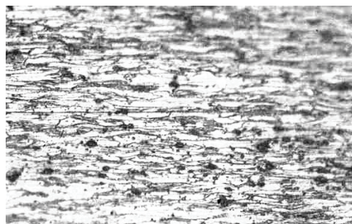
Рис. 2. Холодная деформация при комнатной температуре, x200
