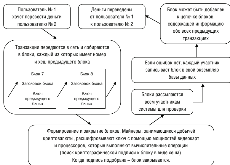
Рис. 1. Технология обработки транзакций Blockchain
